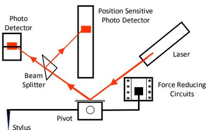
**Figure 3** D-Series Sensor Schematic
